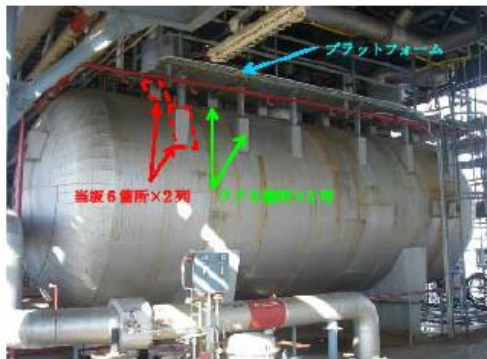
図-9 塩酸塔還流槽の外観（第三塩化ビニルモノマー製造施設の同機器）
