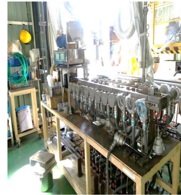
二軸押出機×二軸延伸機による リチウムイオン電池用セパレータの開発
